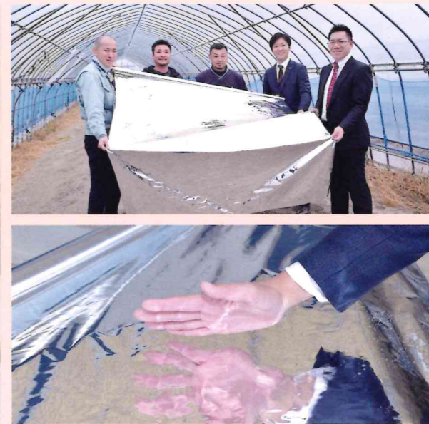
▲(下)表面が鏡のようにキラキラと反射するアルミ蒸着シートです。このアルミ層が太陽光の入射を適度にさえぎりシート下の温度上昇を抑えます。
